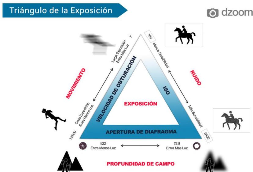
Nota. La Figura 63 muestra una imagen que ilustra el triángulo de exposición de una cámara y sus efectos en la fotografía. Fuente: <https://www.dzoom.org.es/los-tres-elementos-que-afectan-a-la-exposicion-en-tus-fotos/>
