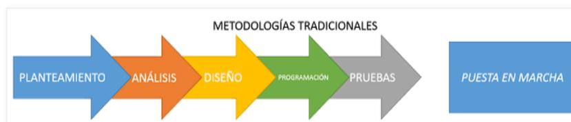
*Nota.* En la figura “Fases del Modelo en Cascada” se detallan las fases del modelo en cascada. Fuente: <http://ingenieriaabril.blogspot.com/2016/09/metodologias-para-el-desarrollo-de.html>.
